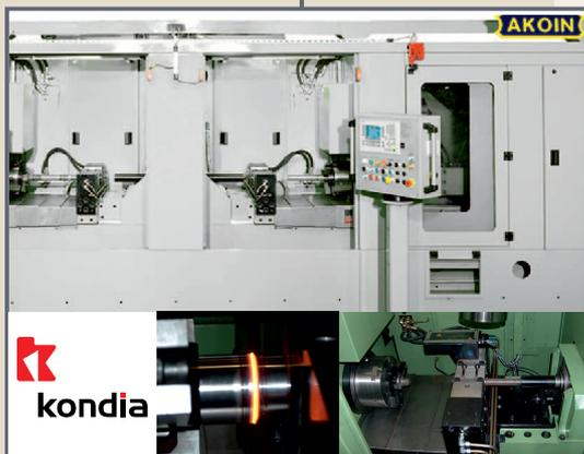
**Endenbearbeitung:** Mit der KONDIA Endenbearbeitungsmaschine werden die Enden des Werkstücks gleichzeitig gefräst. Dank dem Einsatz von gesteuerten Bearbeitungsachsen und Werkzeugwechsler können Zentrierungen, Flächen, Fasen und andere Bearbeitungen in einer Aufspannung ausgeführt werden. Die Maschinen können auch mit automatischen Be- und Entladesystemen ausgerüstet werden.
