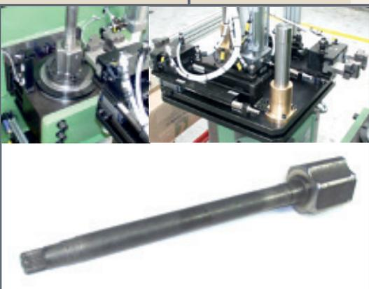
**Drehmaschine:** Die CNC Drehmaschine von KONDIA mit optionalem automatischem Be- und Entladesystem können für die Nachbearbeitung von reibgeschweißten Teilen sowie für die Herstellung von weiteren Werkstücken mit Dreh- Fräs- und Bohrbearbeitungen bis zu einer Werkstücklänge von 1000mm und einem Durchmesser bis 100mm eingesetzt werden.
