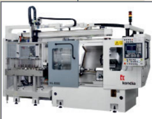
**Reibschweißmaschine:** Die Maschinen mit einer Antriebsleistung bis zu 110kW und einer Stauchkraft bis zu 100t sind geeignet Werkstücke bis zu einem Durchmesser von 110mm zu verschweißen. Das neuzeitliche Steuerungs- und Regelungskonzept garantiert eine einheitliche Reproduzierbarkeit der gewählten Schweißparameter.
