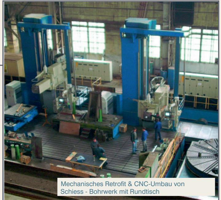
Mechanisches Retrofit & CNC-Umbau von
