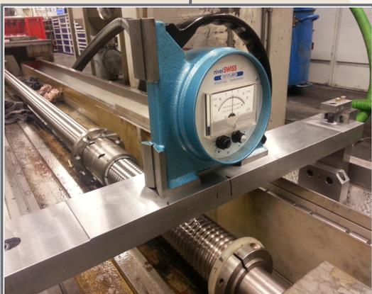
**Geometrievermessung:** Die Grundlage für eine fachmännische Geometrieerstellung ist das vorgängige Vermessen des Ist-Zustandes (Geometrie, Verschleiss, Ebenheiten, Gewichtsverlagerung, Verfahrswege usw.). Anhand der ermittelten Werte kann entschieden werden, welche Art der Überarbeitung erfolgen muss.
