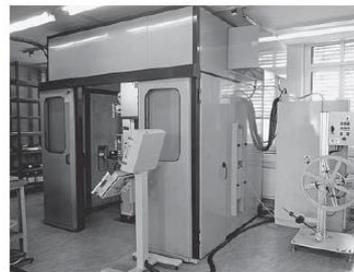
Bild 1: Automatische Presse in einer Schallschutzkabine.
